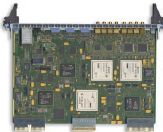
图 2 LSU 软件无线电卡上的赛灵思 Virtex-5 FPGA 和 TI DSP
