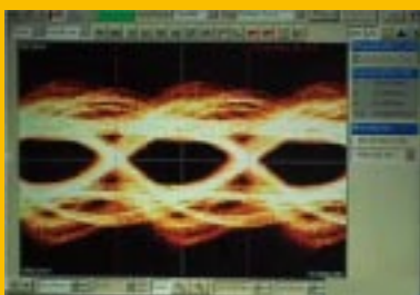
图 4b — 同类竞争产品的 28 Gbps 信号采用的 PRBS7 模式简单得多。该信号噪声很大，眼开小得多。眼开大小参见相对尺度。
